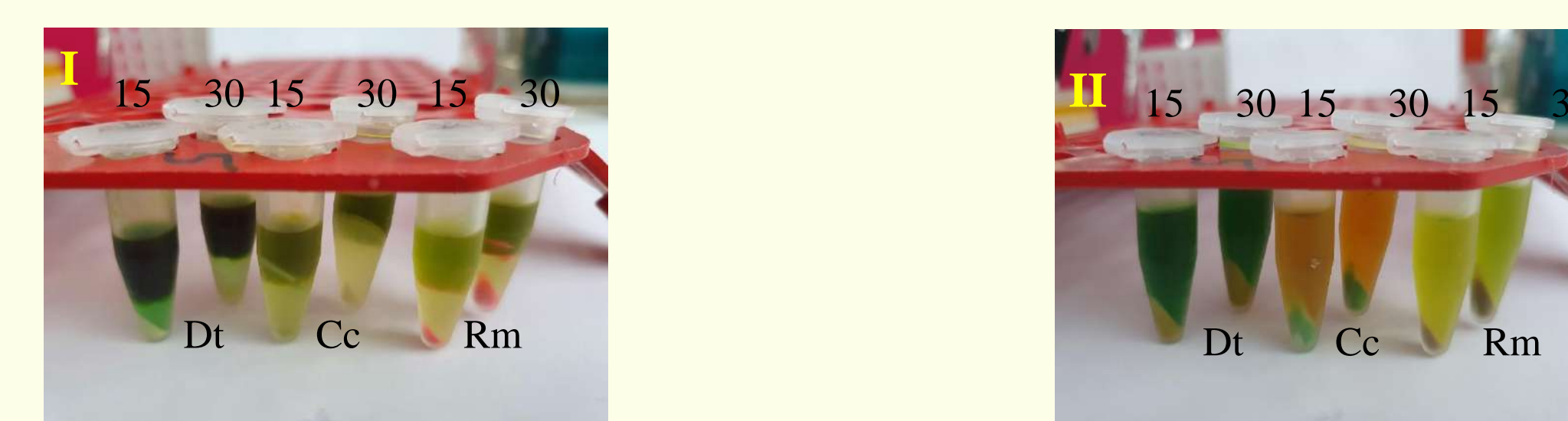
Figura 3. Zdjęcia prezentujące etap 7* ze Schematu (Fig. 2)(ekstrakcja prowadzona z wykorzystaniem układu rozpuszczalników I- aceton: eter dietylowy: eter naftowy (AEE), II- metanol: octan etylu: octan amonu (MOO)).
