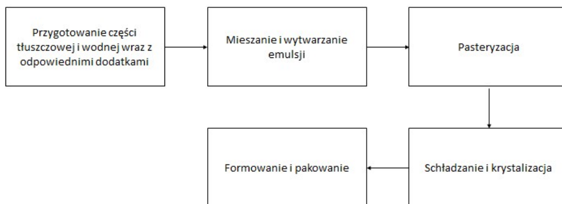
Rysunek 2. Etapy produkcji margaryny
